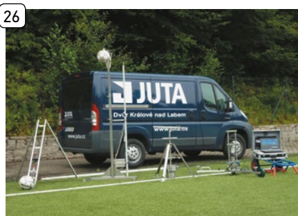
Měření herních parametrů dle FIFA
